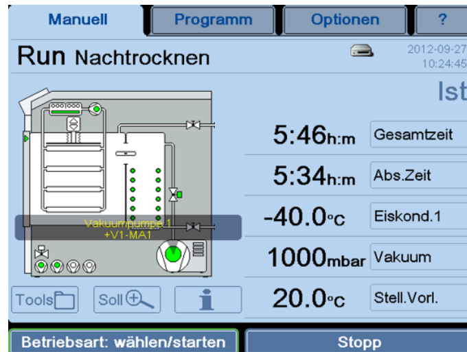
Abb. 28: Darstellung eines Anlagenschemas mit Bezeichnung und Betriebsmittelkennzeichen
