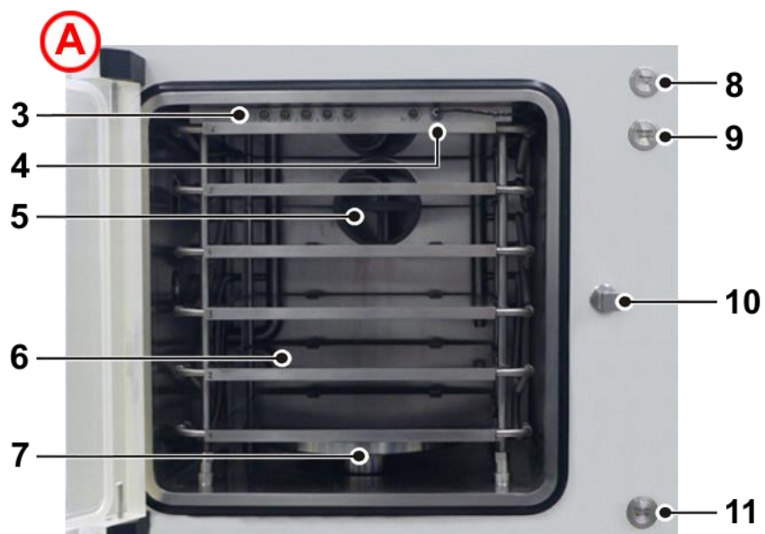
Abb. 2: Detailansicht A – Trocknungskammer
