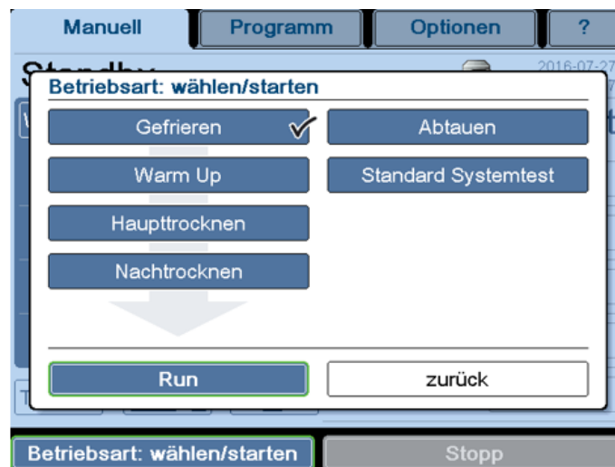
Abb. 32: Dialogfenster "Betriebsart wählen / starten" (Anzeige variiert je nach Ausstattung der Gefriertrocknungsanlage)
