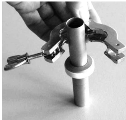
Abb. 77: Ansetzen des Spannrings
