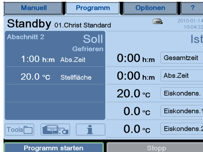
Abb. 74: Mit "Programm starten" wird der Gefriertrocknungsprozess in Gang gesetzt.
