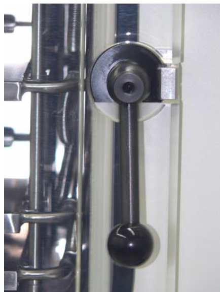
Abb. 17: Türverschluss einer Beladetür; hier: Türanschlag links (Beispiel)
