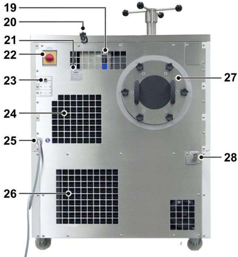
Abb. 6: Rückseite einer luftgekühlten Gefriertrocknungsanlage
