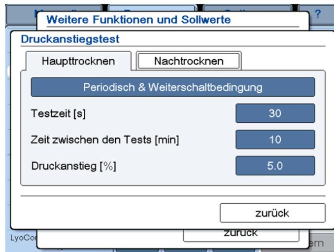
Abb. 67: Dialogfenster "Druckanstiegstest" im Programmmodus
