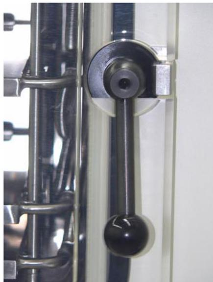
Abb. 19: Türverschluss einer Beladetür; hier: Türanschlag links (Beispiel)
