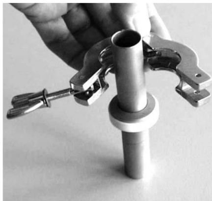
Abb. 76: Ansetzen des Spannrings
