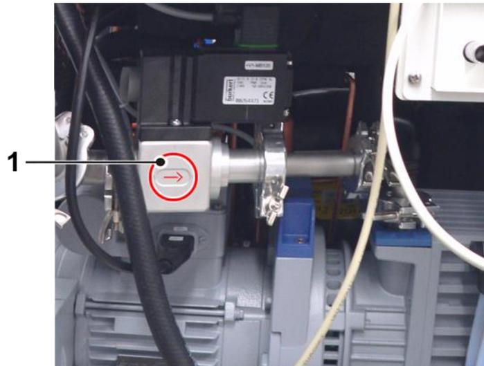
Abb. 14: Drucksteuerventil im eingebauten Zustand, Ansicht von der Seite (Beispiel)
