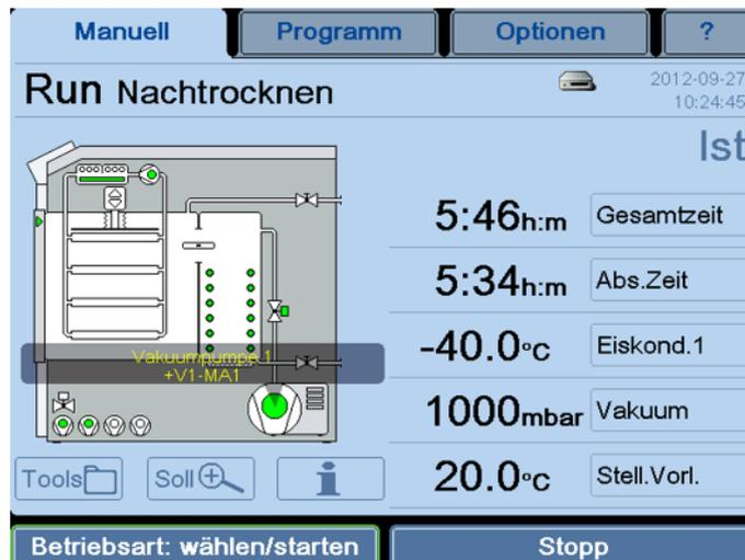
Abb. 27: Darstellung eines Anlagenschemas mit Bezeichnung und Betriebsmittelkennzeichen
