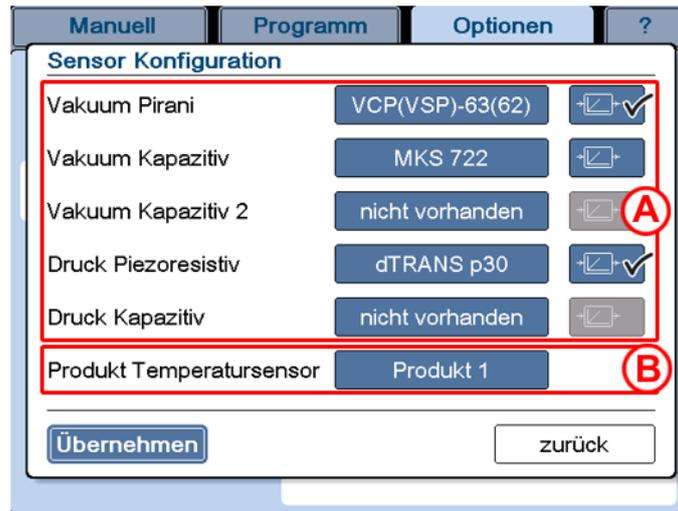
Abb. 49: Dialogfenster "Sensor Konfiguration" (Beispiel)
