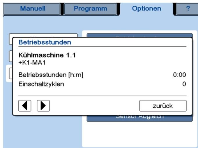
Abb. 53: Dialogfenster "Betriebsstunden", hier: Kühlmaschine 1.1
