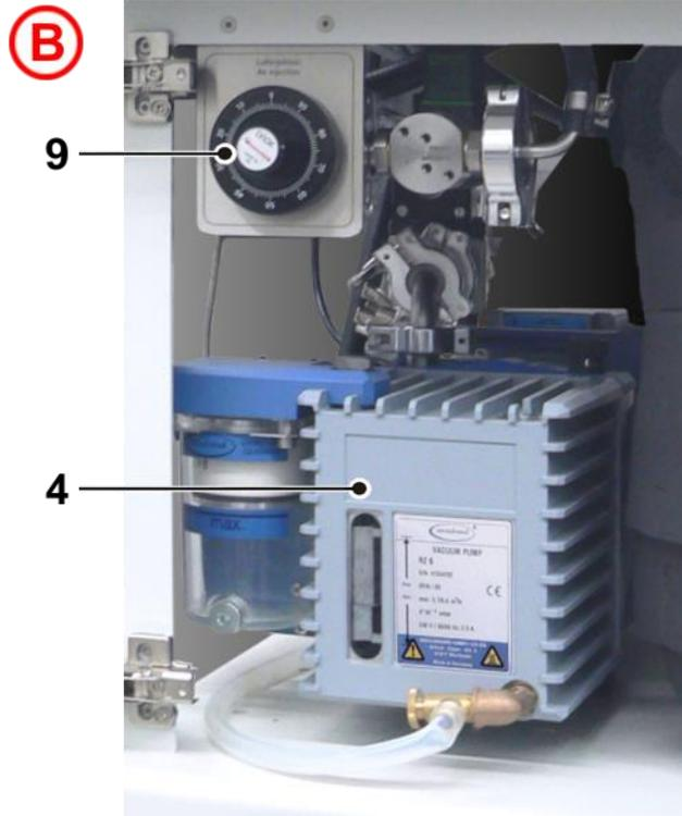
Abb. 3: Detailansicht B - Vakuumpumpe
