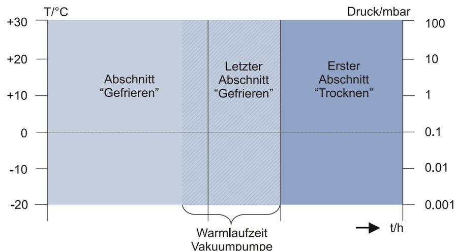
Abb. 63: Die WarmUp-Phase der Vakuumpumpe wird direkt vor den ersten Trocknungsabschnitt in die Phase "Gefrieren" vorgelagert
