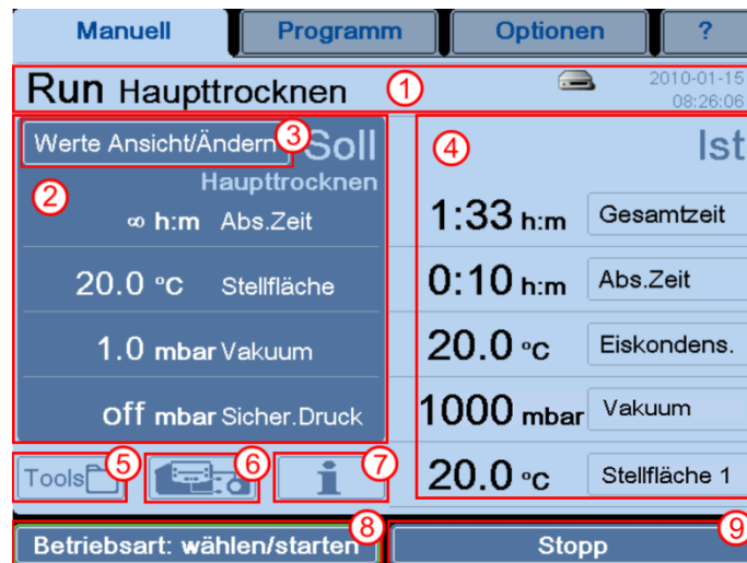
Abb. 77: Bedienoberfläche der LSCplus-Steuerung
