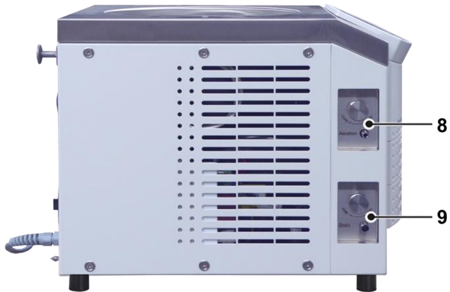
Abb. 74: Linke Seite der Gefriertrocknungsanlage
