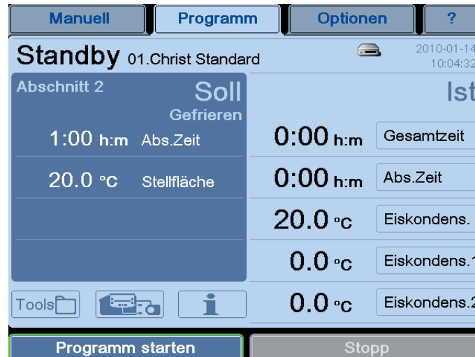
Abb. 65: Mit "Programm starten" wird der Gefriertrocknungsprozess in Gang gesetzt.
