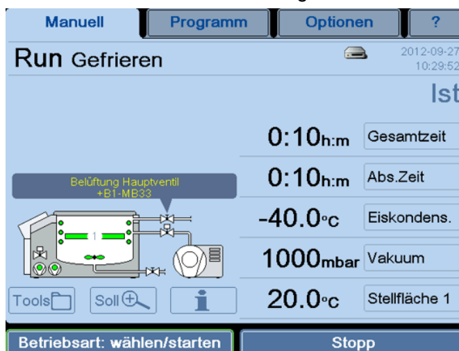
Abb. 24: Darstellung eines Anlagenschemas mit Bezeichnung und Betriebsmittelkennzeichen
