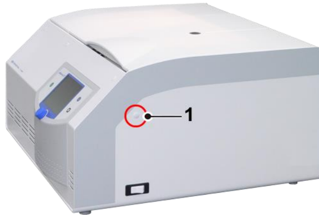
Abb. 29: Position der Öffnung für die Notentriegelung
