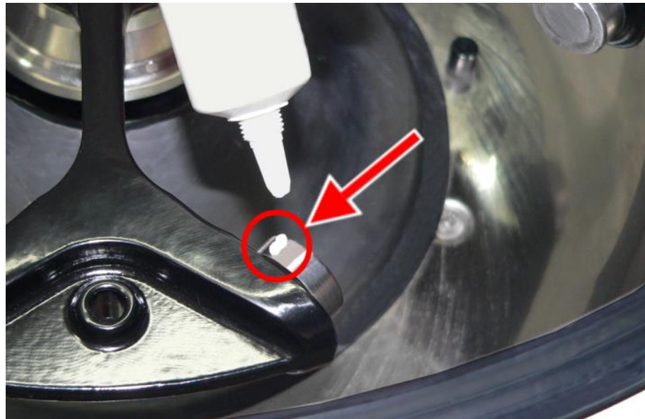
Abb. 30: ausreichende Menge Tragbolzenfett für einen Bolzen
