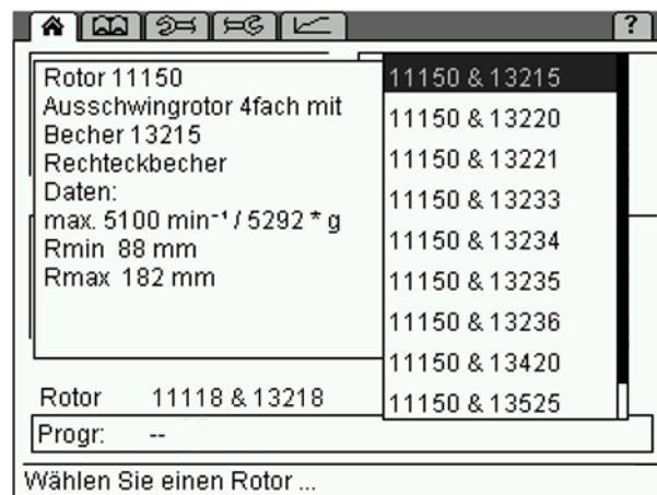
Abb. 12: Rotorauswahlliste, hier für einen Ausschwingrotor
