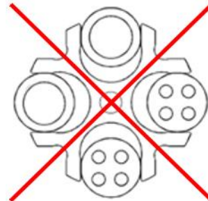
Abb. 6: Zulässige und unzulässige Beladung des Ausschwingrotors mit unterschiedlichen Gläsergrößen (Beispiel)
