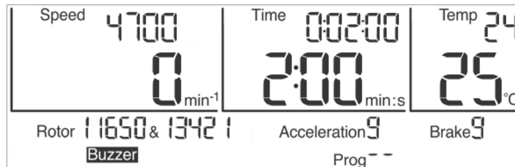
Abb. 20: Anzeige (Maximal aufgetretener Wert blinkend) bei Überschreiten der Alarmtemperatur
