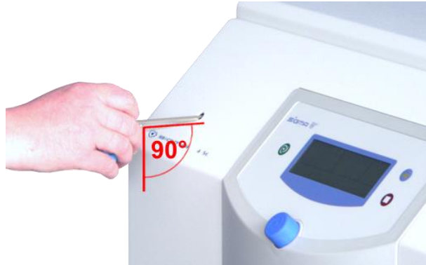
Abb. 32: Der Notentriegelungsschlüssel muss waagrecht eingesteckt werden
