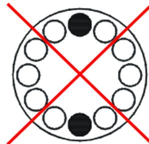
Abb. 9: Zulässige und unzulässige Beladung eines Winkelrotors (Beispiel)
