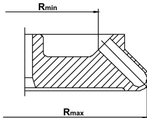
Abb. 13: Minimal- und Maximalradius eines Winkelrotors
