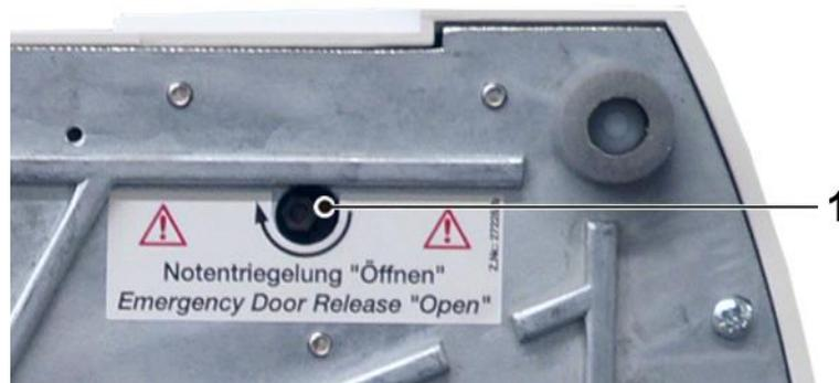
Abb. 12: Öffnung für die Notentriegelung an der Unterseite der Zentrifuge
